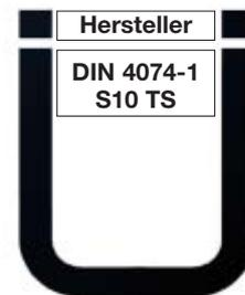
**Abb. 11:** ÜZ - Übereinstimmungszertifikat bei maschineller Sortierung
